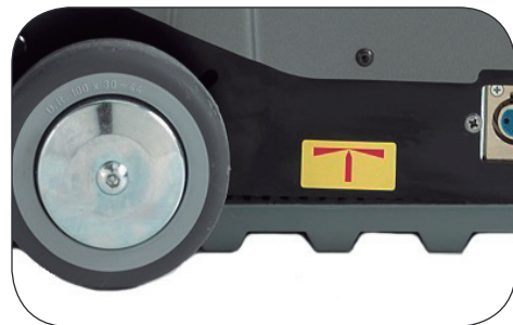
4. Punto de equilibrio: indica cuándo se debe detener la marcha e inclinar la máquina.
