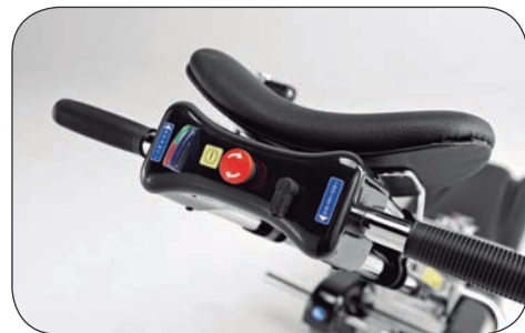
6. Manillar con pulsadores de avance, marcha y emergencia e indicador de pendiente.
